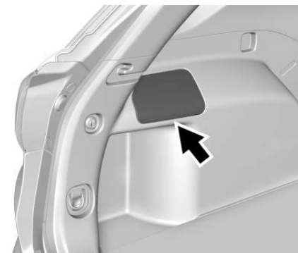
Блок предохранителей в заднем багажнике
